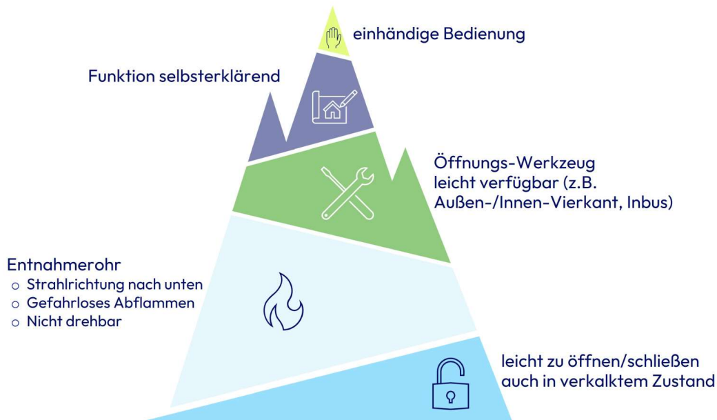
Bild 8: für eine regelwerkskonforme Probenahme muss das Probenahmeventil wichtige Eigenschaften aufweisen
