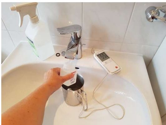
Bild 1: Die exakte Vorgehensweise bei der Entnahme von mikrobiologischen Proben ist Grundvoraussetzung für eine aussagekräftige Ursachenforschung.
