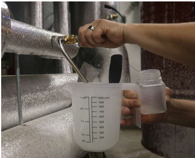
Bild 6: Zur Entnahme von Proben müssen mehrere Tätigkeiten mit verschiedenen Geräten gleichzeitig ausgeführt werden.
